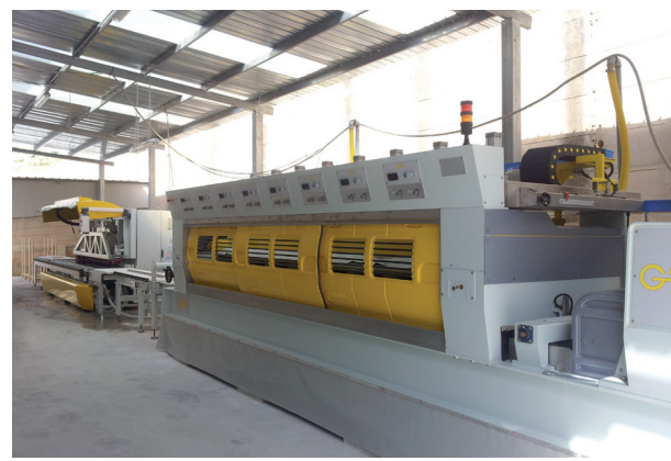
In line with bull nose polishing machine Linea lucidatura con lucidatore
