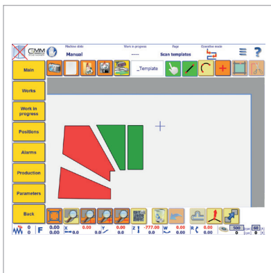
COD. A6423 OPTICAL TEMPLATE COPIER RILEVATORE OTTICO DI DIME
