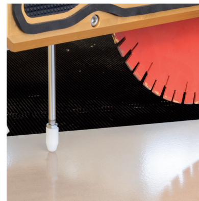
COD. A5504 SLAB THICKNESS READER LETTORE SPESSORE LASTRA
