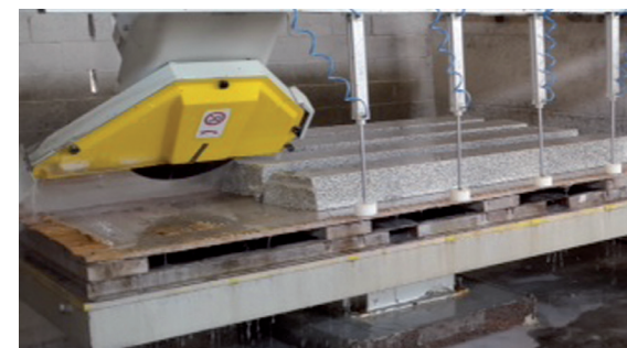
Inclined cuts. Tagli inclinati.
