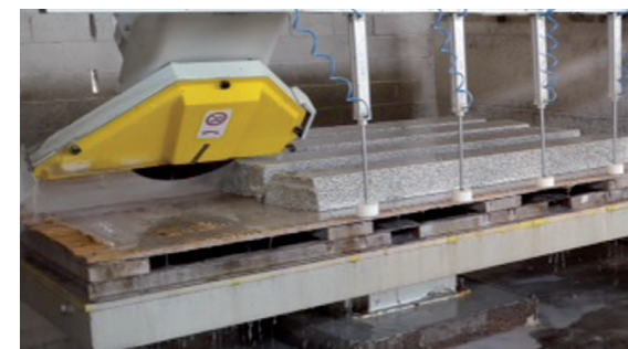
Inclined cuts. Tagli inclinati.
